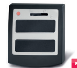
Innentaster Signal 112 Starttaste, Urlaubsschalter, Dauerlicht (Ein/ Aus), 24 V Anschluss am Antrieb, aus UV-beständigem Material
